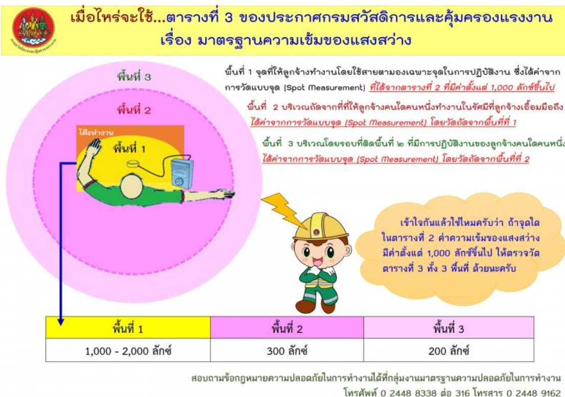
ภาพที่ 16 การตรวจวัดความเข้มของแสงสว่างการวัดแบบเฉพาะจุดแบบวัด 3 พื้นที่
