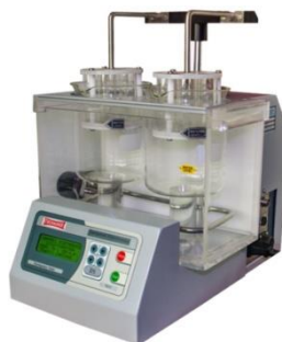
ภาพที่ 33 เครื่องมือที่ใช้ในการทำบทปฏิบัติการที่ 9 เรื่อง การทดสอบการละลายตัวของเม็ดยา
