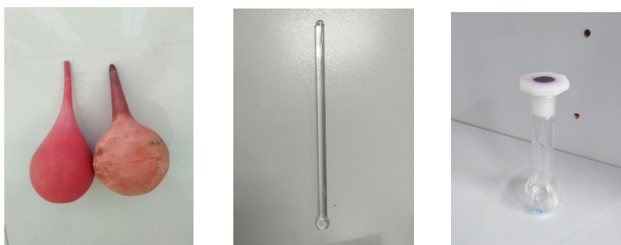
(5) ลูกยางแดง (Syringe Ball) (6) แท่งแก้วคนสาร (7) ขวดวัดปริมาตร
