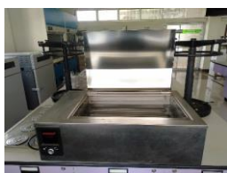
(1) เครื่องอังน้ำ (Water bath)
