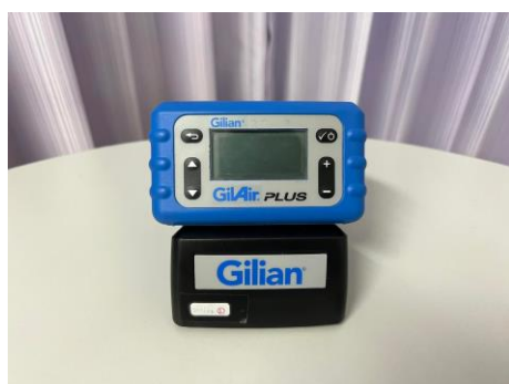
(1) ป้มนวดตัวอย่างอากาศ รุ่น Gilair Plus
