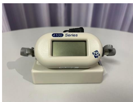
(2) เครื่องปรับเทียบความถูกต้อง (Primary Calibrator)
