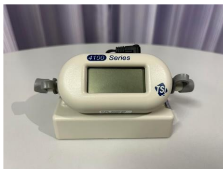
(2) เครื่องปรับเทียบความถูกต้อง (Primary Calibrator)
